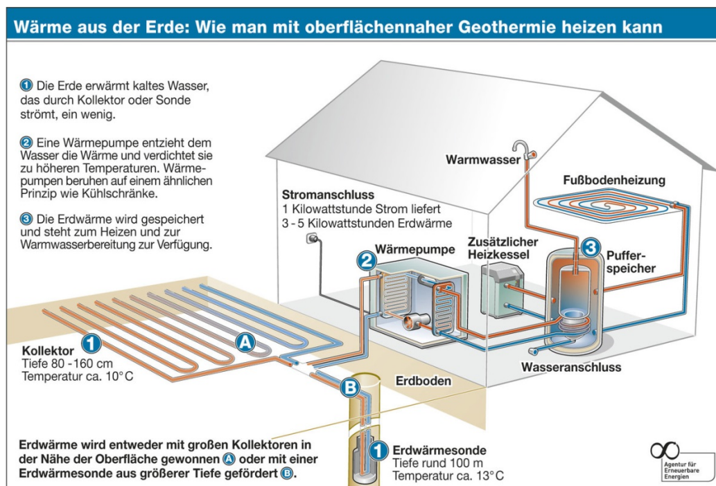
Abb. 10: Wie funktioniert oberflächennahe Geothermie? (Quelle: Agentur für Erneuerbare Energien)
