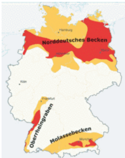
Abb. 11: tiefengeothermische Regionen Deutschlands. Aquifere mit Temperaturen über 60°C = orange, über 100°C = rot. (BMU-Broschüre 2010 „Nutzungsmöglichkeiten der tiefen Geothermie in Deutschland“)
