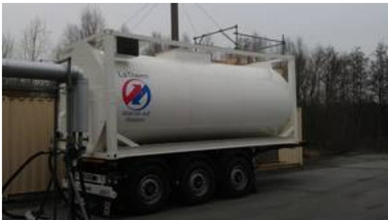
Abb. 28: Mobiler Wärmespeicher (Bild: LaTherm Energie AG)
